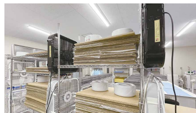
開被・洗浄後の資料乾燥。エアストリーム乾燥法採用で、大量でも迅速に
